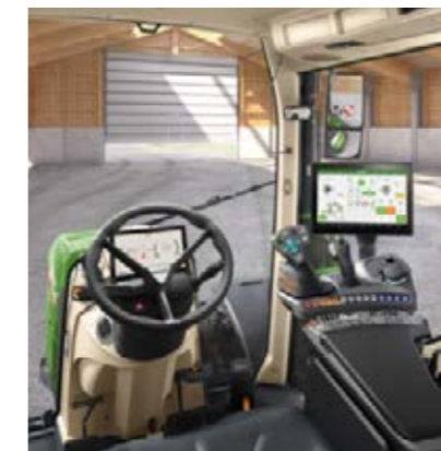
Profi Setting 2 - Joystick 3L - Une paire de commandes en ligne (fingertips) pour commander les distributeurs hydrauliques - Terminal 12"
