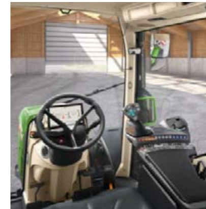
Power Setting 1 - Sans levier en croix - Une paire de commandes en ligne (fingertips) pour commander les distributeurs hydrauliques
